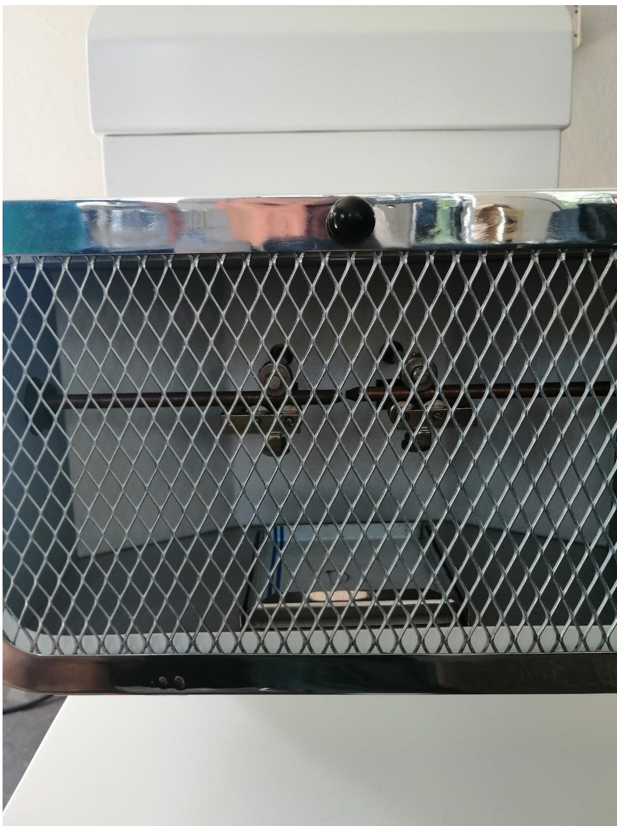
Rys.nr 2. Wygląd ustawienia elektrod po zamknięciu klapy zabezpieczającej Urządzenie Plasma Light jest teraz gotowe do pracy.
